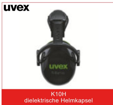
Dämmwert für leichte Lärmbelastung (SNR 28 dB). Helm kapsel-GH uvex K10H dielektrisch Euroslot 30mm Gehörschutz kapsel dielektrisch für die direkte Helmanbindung im 30mm Euro-Slot. Durch die Dreh- und Schwenkbewegung ist es möglich die Kapseln einfach und schnell in die Arbeits-/Bereitschafts- und Parkposition zu bewegen. Dichtkissen aus Memory Foam für eine gute Abdichtung und Anpassung am Kopf.
