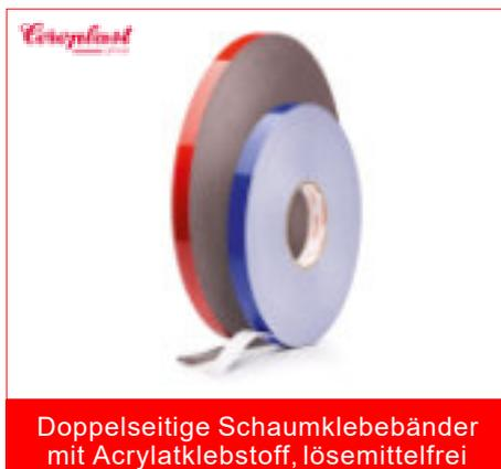
Doppelseitige PE-Schaum-Klebebänder für die dauerhafte Verklebung von Leisten, Profilen und Sprossen, ausgerüstet mit feuchtigkeitsunempfindlichem UV-vernetztem Acrylatklebstoff, für Anwendungen im Innen- und Außenbereich, lösemittelfrei und emissionsarm, hohe Resistenz gegenüber Chemikalien und anderen äußeren Einflüssen, sehr gute Anfangs- und Endklebkraft, gute Alterungs- und Temperaturbeständigkeit.
