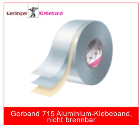
Gerband 715 ist ein Aluminiumklebeband mit einem sehr klebstarken, stark vernetzten Polyacrylat-Haftkleber von hoher Hitzebeständigkeit und hoher Scherfestigkeit. Es wird für Verklebungen unter hohen Temperaturbelastungen sowie zur Ummantelung, Isolierung, Abdichtung und Hohlraumversiegelung verwendet.
