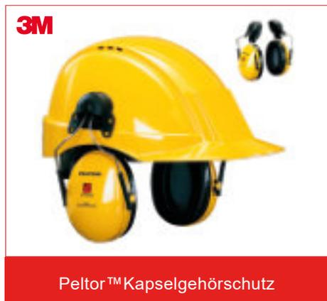
Das Modell hat eine Steckbefestigung für Helme mit 30 mm Schlitz, passend für alle Peltor™ Helme mit Ausnahme des G2000. Der Kapselgehörschutz hat gelbe Kapseln und einen Dämmwert von SNR = 28 dB. Dank des schlanken Kapseldesigns liegt der Gehörschutz bequem und sicher an. Die Zwei-Punkt-Aufhängung garantiert einen konstant niedrigen Anpressdruck.
