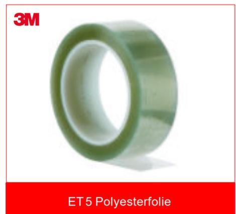
Die transparente ET5 Polyesterfolie mit Acrylkleber hat eine Durchschlagsspannung von 5500 V. Isolierstoffklasse: B (130 °C). Anpassungsfähig, weist hervorragende Beständigkeit gegen Chemikalien, Lösemittel, Feuchtigkeit, Abrieb und Einschnitte auf.
