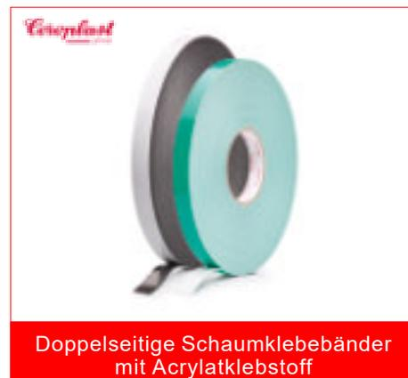
PE-Schaum-Klebebänder mit unterschiedlichen Raumgewichten für die dauerhafte Verklebung von Leisten, Profilen und Sprossen, Prüfzeugnisse des LGA und des IFT Rosenheim bestätigen die Eignung für den Verbau in der Fenster- und Glasindustrie, im Glaserhandwerk sowie in der Möbelindustrie, einsetzbar für das Fügen und Verkleben von vielen verschiedenen Untergründen wie Metall, Glas, Kunststoffen und Holz.
