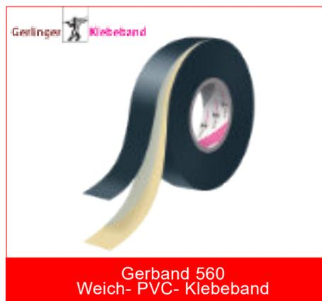
Gerband 560 ist ein reißfestes Weich-PVC-Klebeband mit einem stark klebenden, kältefesten und hitzebeständigen Naturkautschukkleber. Es wird zum Abdichten und Ummanteln von Isolierstoffen, als Endbandage um Isolierschalen und -manschetten, zum Abdichten von Rohrleitungen, Lüftungskanälen und Behältern Mit hygroskopischem Füllgut sowie Zum Kennzeichnen und Bündeln verwendet
