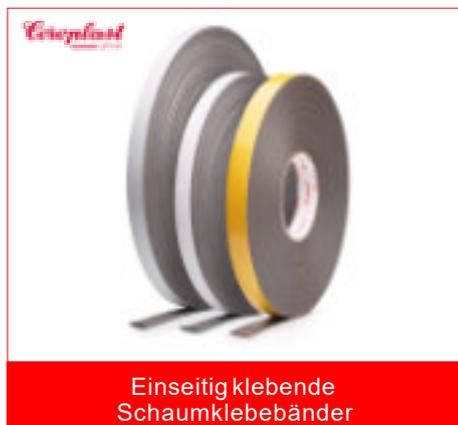
Geschlossenzellige, einseitig klebende Polyethylenschaum-Klebebänder, ausgerüstet mit lösemittelfreien, emissionsarmen Acrylatklebstoffen, zum Abdichten, Dämmen, Schützen oder Weichlagern verschiedener Substrate, hohe Anfangshaftung, die aber Korrekturen kurz nach Beginn der Verklebung zulässt, sehr gute Endklebkraft, sehr gute Alterungsbeständigkeit, in Stärken von 1,0mm bis 5,0 mm lieferbar.
