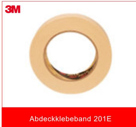
Das Abdeckklebeband 201E ist ein geschmeidiges, chamoisfarbenes, 0,135 mm dickes Kreppklebeband mit Kautschuk-Klebstoff für Arbeiten bis zu 80 °C. Es eignet sich zum Zusammenhalten, Befestigen, Einpacken und Verschließen. Anschmiegsames Klebeband, das beim Abrollen nicht reißt. Lässt sich leicht abrollen. Einfach zu beschriften. Für allgemeine vorläufige Lackierarbeiten.
