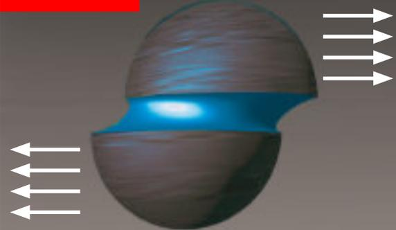
Die **Scherkraft** wirkt auf eine überlappende Verbindung und bringt die Substrate dazu, übereinander zu gleiten.
